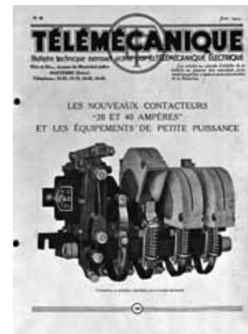
1934 : le nouveau contacteur 40 A tripolaire pour courant alternatif
