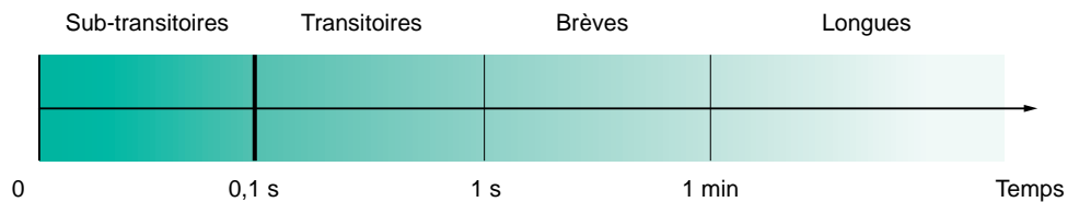
fig. 1 : perturbations de tension dans les réseaux.
